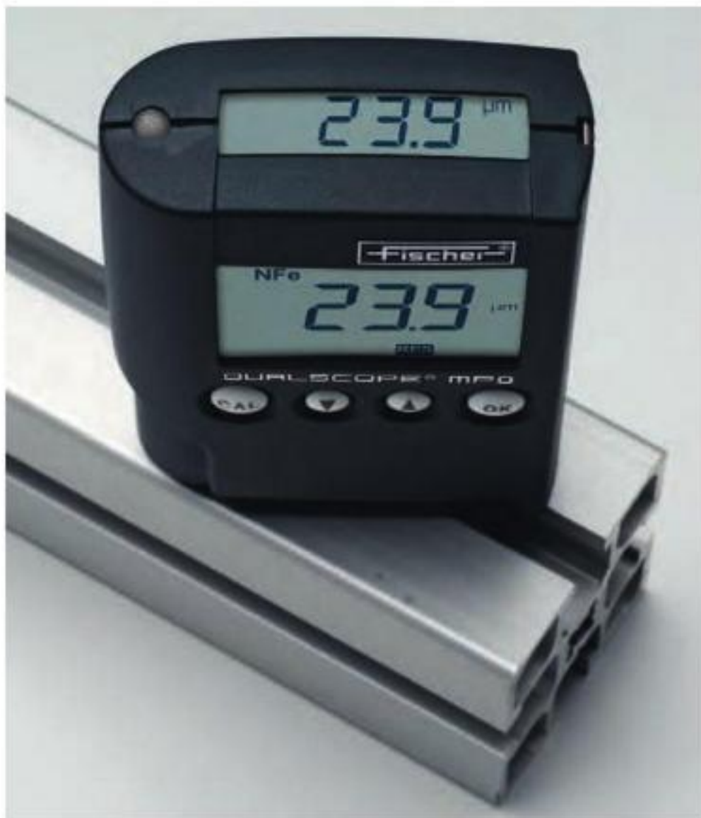
测量铝上阳极氧化膜的厚度
