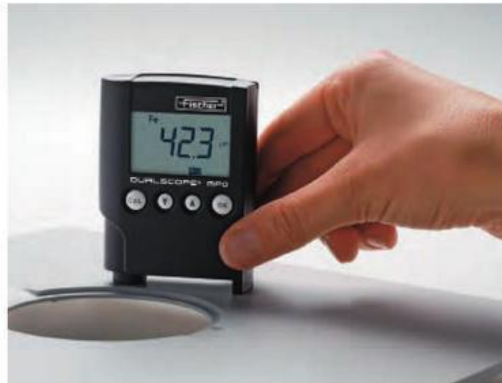
测量铁上油漆的厚度
